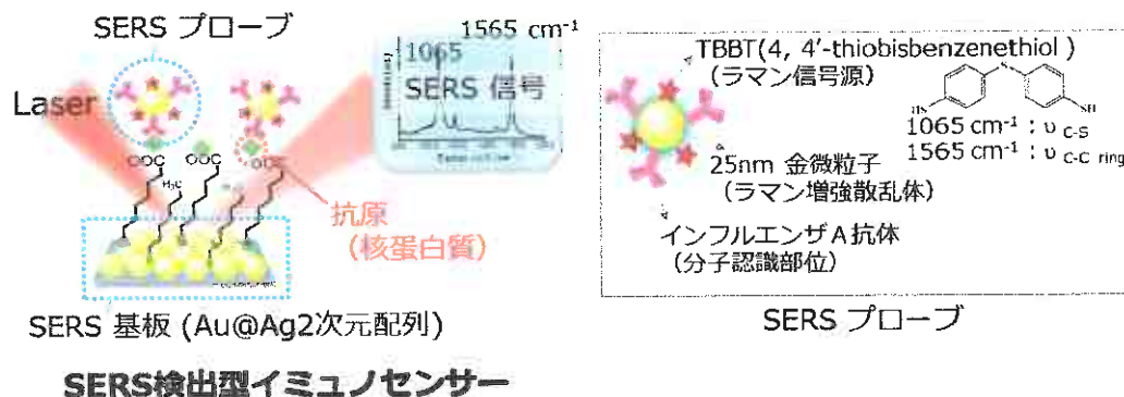
図7 研究開発したセンサーの概念図と SERS プローブの内部構
