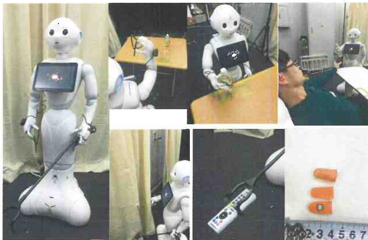
図3 介護支援作業を目的としたPepperのつもり制御：Pepper本体（左図）を無改造のまま利用するために、外付けで「レーザーライン投光器」（上段中央左図）「把持サポート紐」（上段中央右図）「マジックハンド」（下段中央右図）の3つのパーツを装着する。これらは装着にあたってPepper本体を加工する必要が無く、また別途機能によって駆動する必要の無い「Pepperが使う道具」として機能するものを選択しているため、実運用を想定したとしてもその普及は容易なものを選択している。操縦は外耳道に挿入された加速度センサ（下段右図）によって検出された外耳道壁の意識下応答から「つもり制御」によって実施される（上段右図）。
