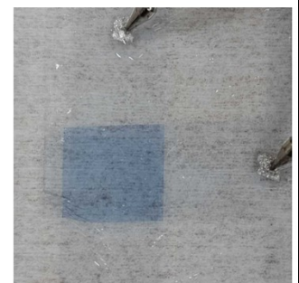
図 5. 極薄伸縮性 ECD。(左)構造。(右)動作している様子。
