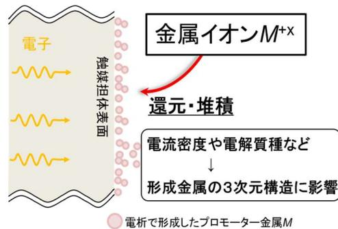
図1. 電析法によるプロモーター形成の概念図
